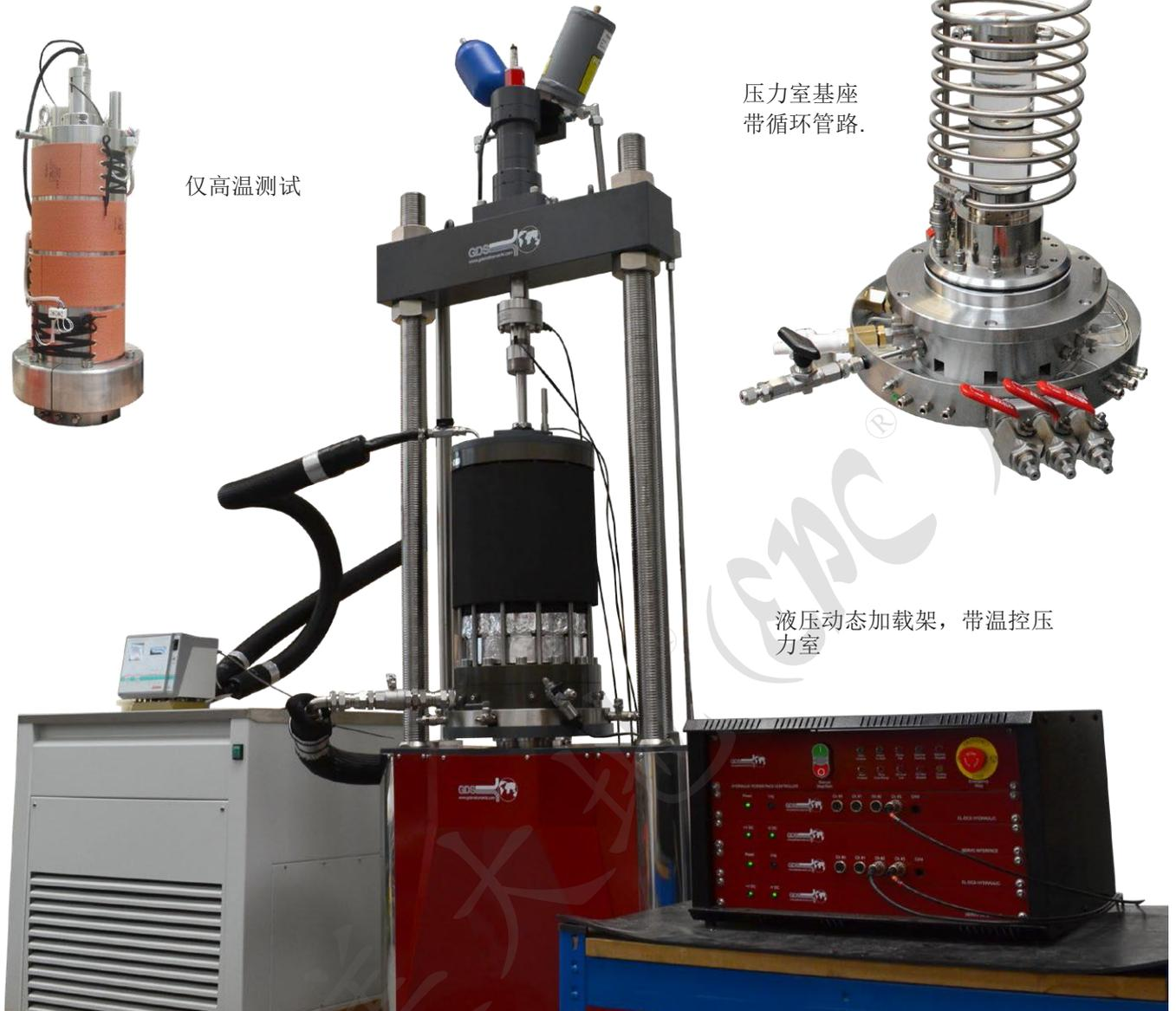
液压动态加载架，带温控压力室
