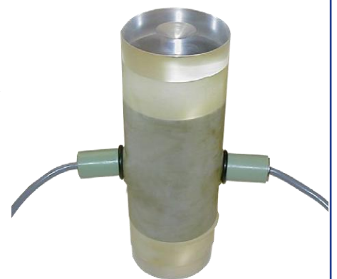
图2 安装于试样上的水平弯曲元
