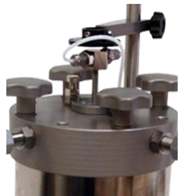
图 3 GDS Rowe & Barden 固结压力室 外置轴向位移测量
